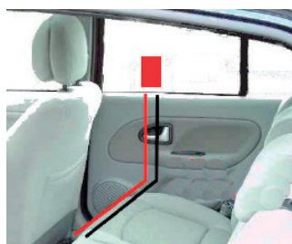
Flexible Kabellänge und Ort der Befestigung Transponder
