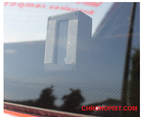
Transponderen monteres af løbets officials ved teknisk kontrol, og den placeres nederst i højre siderude.
