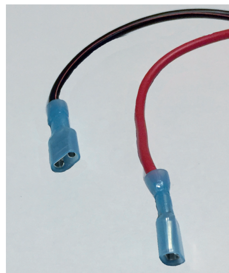
Kablerne ved transponderen skal være tilpas lange, så de ikke "trækker" i enheden og forsynes med kabelsko af typen med isolering på hele stikket
